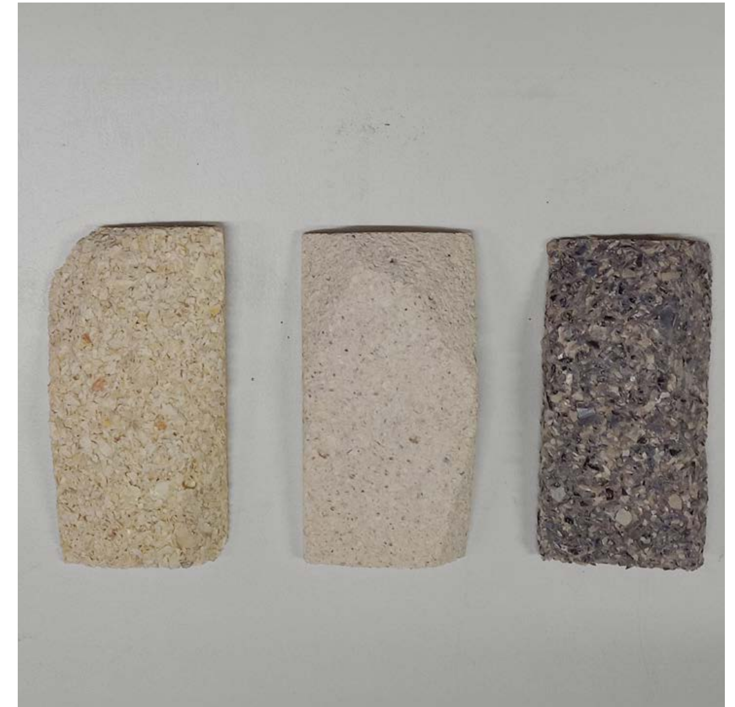
Skal baseret beton
